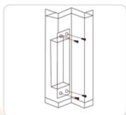
二、找准相应的位置将连接板安装到门框上
